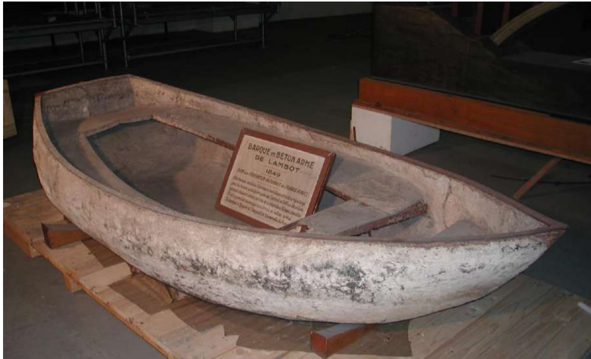
Barque en béton armé, Exposition Universelle de 1855
